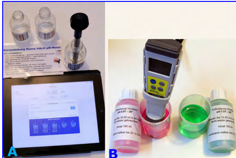
Abb. 12. pH-Kalibrierung (Eichung mit Eichpufferlösungen).
