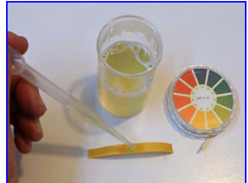
Abb. 6. pH-Grobbestimmung mit Universalindikatorpapier.
