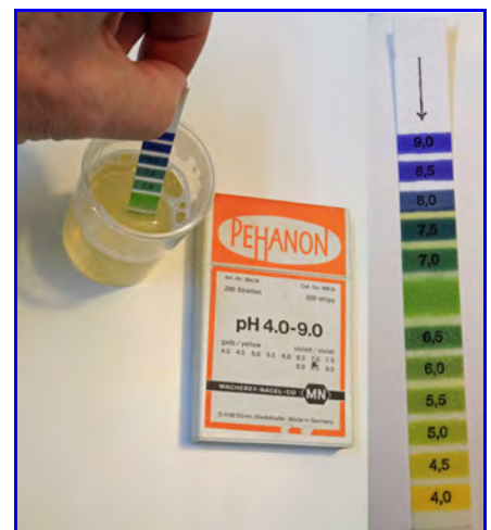
Abb. 7. pH-Bestimmung mit pH-Indikator-teststreifen mit aufgedruckter pH-Skala.
