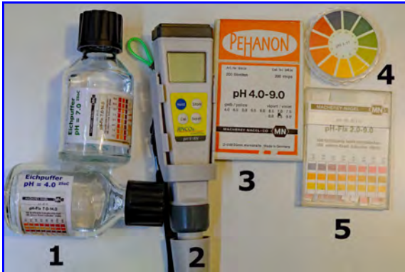
Abb. 1. pH-Messsysteme: pH-Meter, Indikatortests. 1: Pufferlösungen pH 4.0 und 7.0 für Kalibrierung pH-Meter. 2: pH-Meter. 3: pH-Indikatorstreifen. 4: Universalindikator. 5: pH-Indikatorsteststäbchen.
