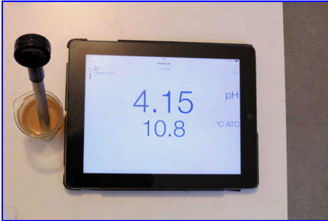
Abb. 17. pH-Bestimmung im kalten Bier.
