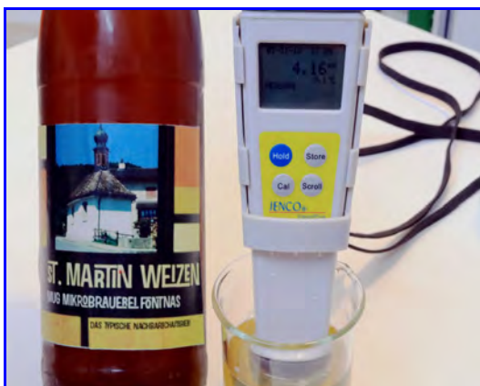
Abb. 15. pH-Bestimmung im selbstgebrauten Weizenbier.
