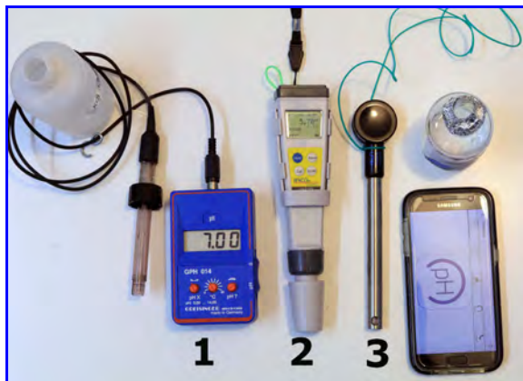
Abb. 10. pH-Meter messen sehr genau den pH-Wert, meist sogar temperaturkompensiert.
