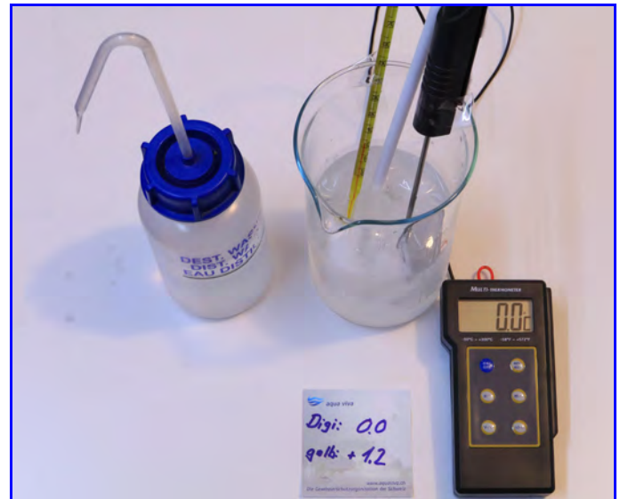
Abb. 4. Kalibrieren mit Eis-Wasser-Mischung.
