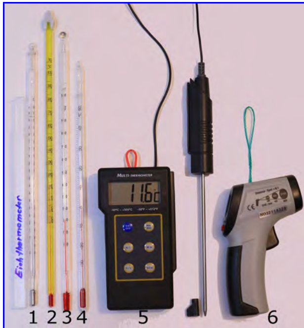
Abb. 3. Typische Messgeräte zur Temperaturbestimmung. Klassische analoge Flüssigkeitsthermometer Nr. 1-4.
